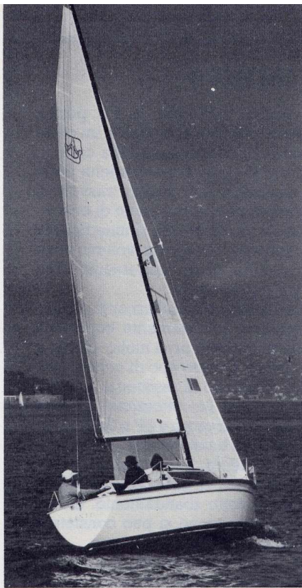
Nel CS, l'inclinazione dell'albero rastremato può essere modificata e si riesce a regolare la pienezza della vela.
